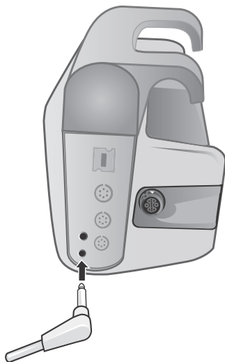
Figure 12-1 Connexion de la sonde de température à l'appareil Propaq MD
