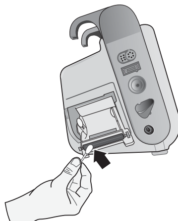
Figure 24-3. Nettoyage de la tête d'impression
