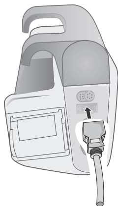
Figure 10-3 Connexion du capteur SpO 2 à l'appareil Propaq MD
